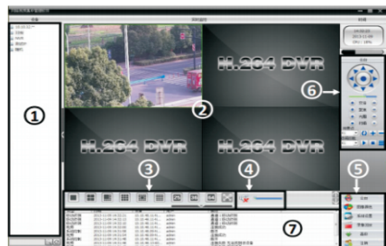
①设备列表显示区 ②预览画面显示区 ③画面分割菜单 ④音量调节 ⑤主菜单 ⑥云台控制菜单 ⑦操作日志显示区
