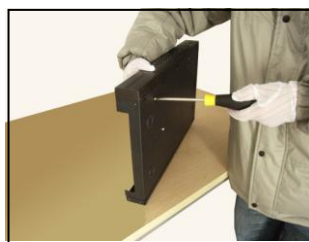
④安装固定硬盘螺丝
