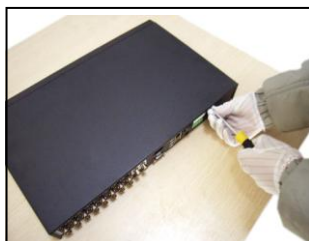
①拆卸主机上盖的固定螺丝
