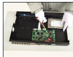
⑥连接硬盘电源线
